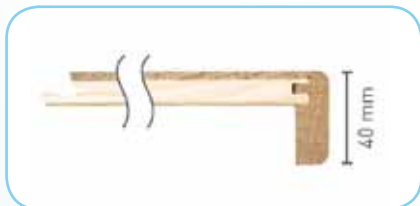
Coupe bloc marche modèle 14/40 mm (contremarche livrée non collée)
