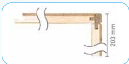
Coupe bloc marche modèle 14/203 mm (contremarche livrée non collée)
