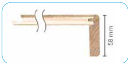
Coupe bloc marche modèle 14/58 mm (contremarche livrée non collée)
